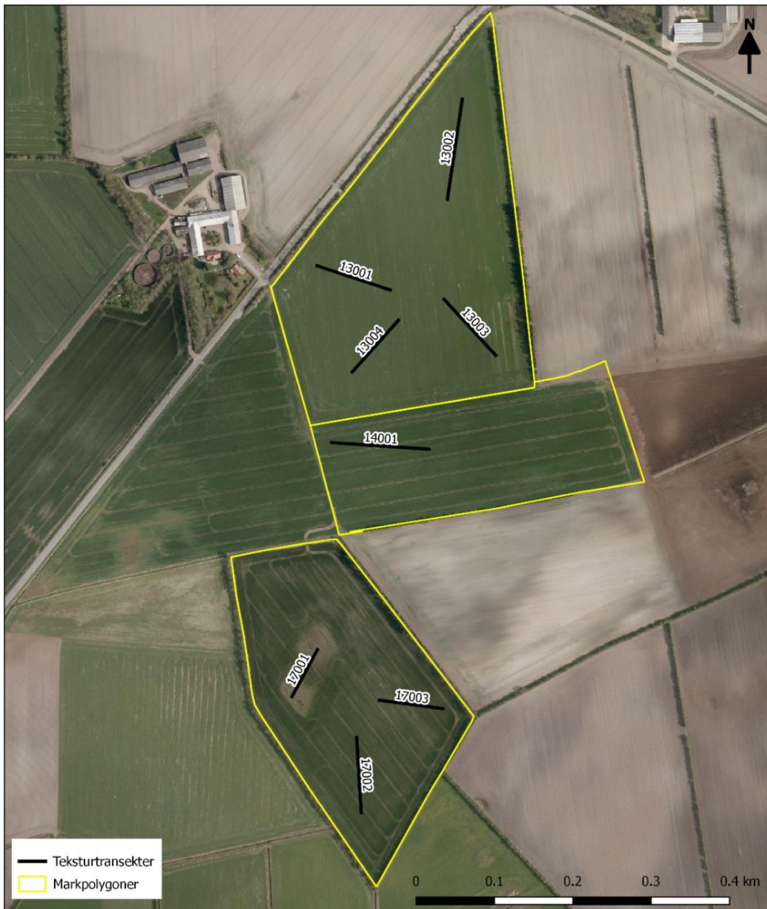
Kortlægning af elektrisk ledningsevne med DualEM-21S
